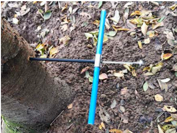
Figuur 2: Höglof sampler (links) en geëxtraheerde boomkern (rechts) - Foto's onderzoek Doetinchem.
